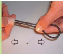
Durch ziehen an den Gummibändern kann die Verschlusskugel eingesetzt und entfernt werden.
